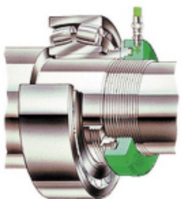
3. Matice HMV E našroubovaná na hřídel před montáží stahovacího pouzdra.
